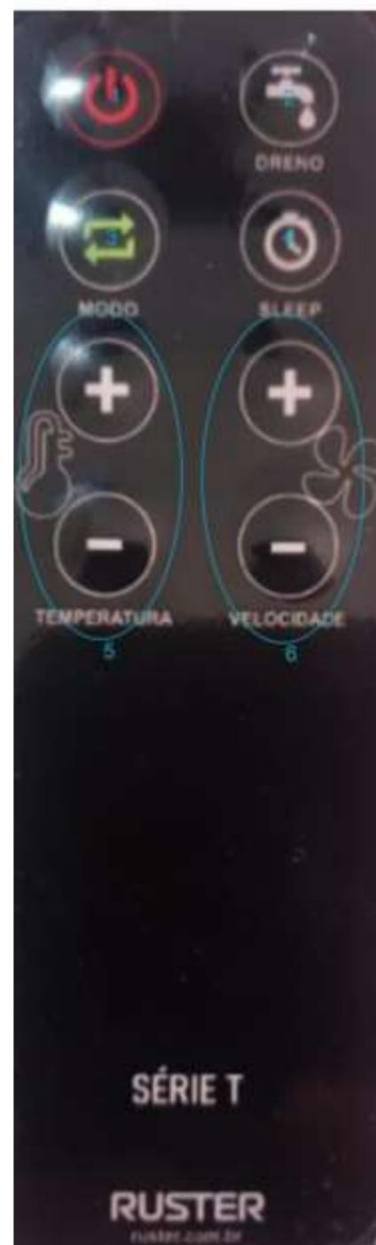
**Botão liga desliga:** Ao pressionar uma vez esse botão, o climatizador inicia a limpeza do painel (LPA) durante 1 minutos seu climatizador limpa os painéis evaporativos após esse tempo inicia a partida do motor.
